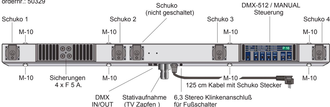
Die BOTEX DMX Four-Bar kann sowohl als 4 Kanal DMX Chaser-Kontroller und auch als DMX-512 Dimmer-Pack mit externer Steuerung eingesetzt werden.
